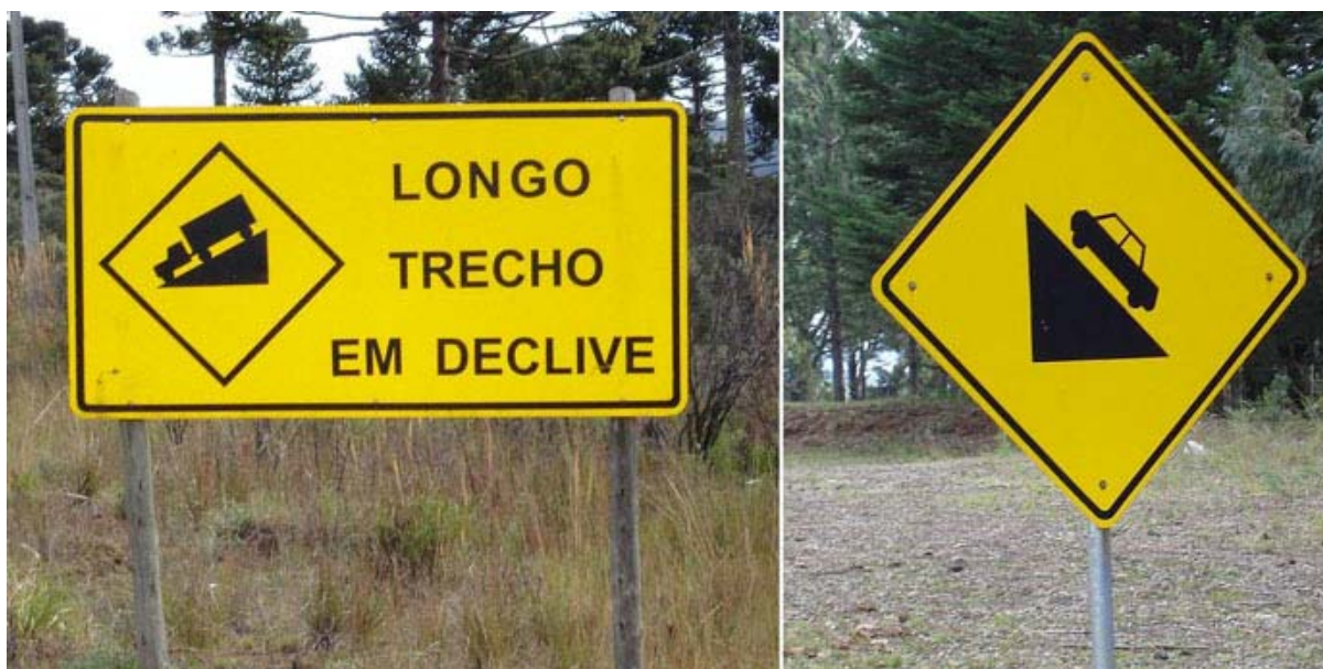
Figura 1 – Placas sinalizando os declives acentuados em rodovias.
