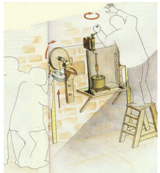
Partes interiores do calorímetro de Joule com sua estrutura de pás fixas e móveis
