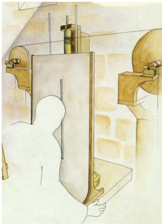
Aspecto relevante das figuras acima: colocação de um anteparo em frente ao termômetro longo para evitar que a respiração interferisse na medida da temperatura.
