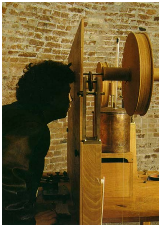
Aspecto relevante das figuras acima: colocação de um anteparo em frente ao termômetro longo para evitar que a respiração interferisse na medida da temperatura.
