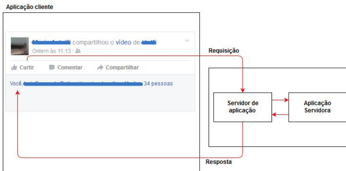
Figura 3: Principal quadro da vídeoaula: apresentado como uma aplicação cliente envia uma requisição e recebe a resposta.
