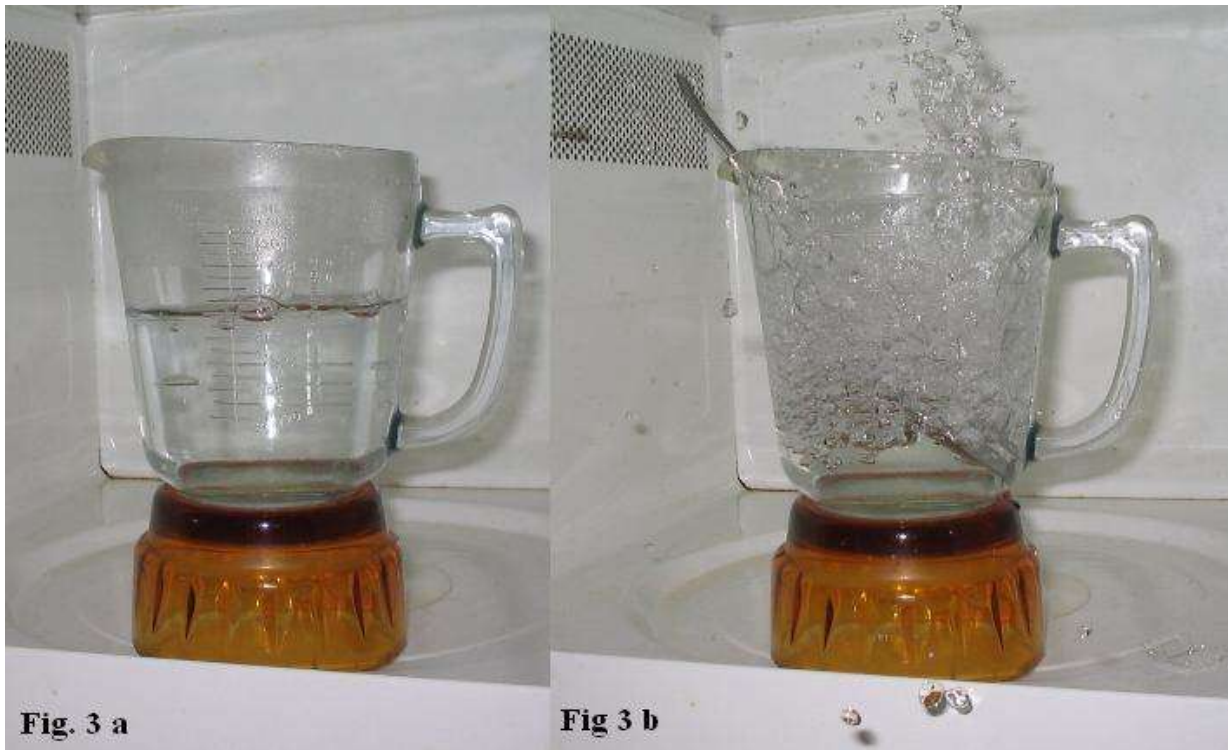
Figura 3 – Explosão da água superaquecida quando uma colher é introduzida no líquido.
