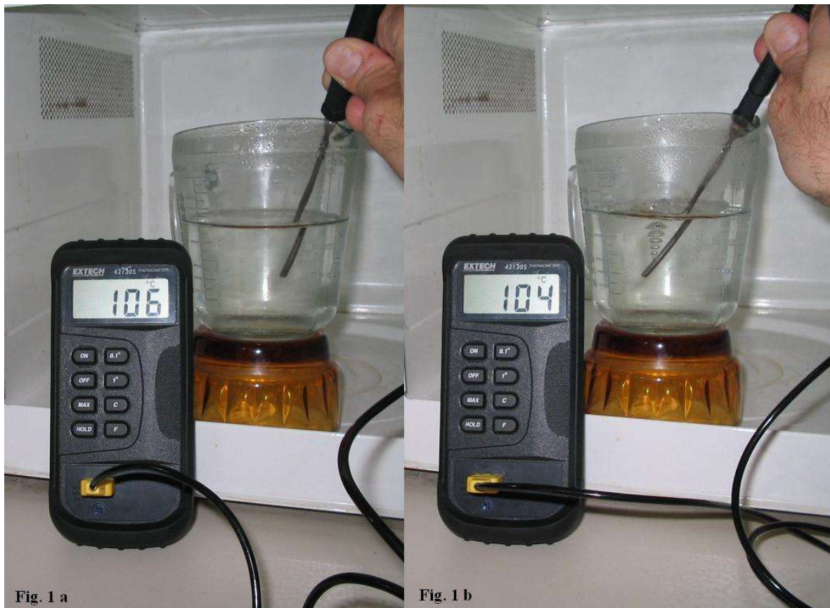
Figura 1 – Detectando temperaturas superiores a do ponto de ebulição da água.
