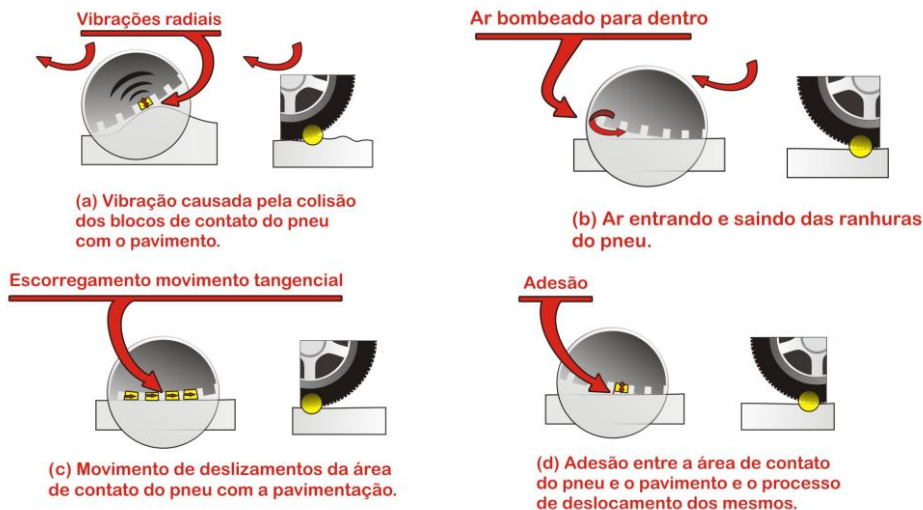
Fig. 2 - Características da interface pneu/pavimento que podem amplificar a emissão de ondas sonoras.
