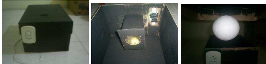
(a) Imagens da caixa fechada (à esquerda) e da caixa entre-aberta, permitindo ver a lâmpada (no centro) e a bolinha presa por um fio à tampa da caixa (à esquerda).
