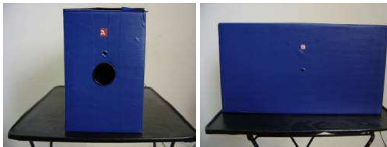
(a) Fotos de duas laterais da caixa: a da esquerda mostra o orifício grande para acoplar a lanterna e o orifício pequeno para visualização da bolinha; a da direita só tem o orifício para visualização da bolinha.
