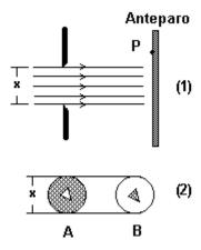
Os dois obstáculos mostrados na figura (2) são colocados, cada qual por sua vez, sobre o orifício colimador. A é um disco opaco com um pequeno orifício e B é o "negativo fotográfico" de A. Usando os conceitos de superposição, mostre que a intensidade da luz no ponto P é a mesma para os dois objetos difratores A e B.
