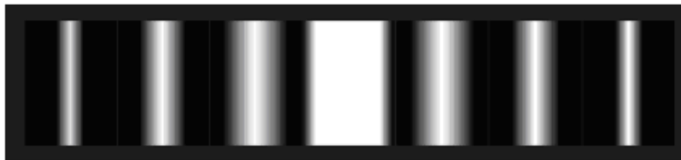
Figura 17 - Figura de difração produzida por uma fenda simples.
