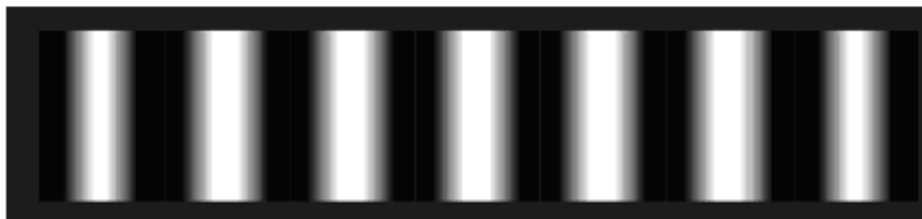
Figura 20 - Figura de interferência produzida por duas fendas.
