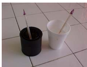
Fig. 3.1: copo e lata com água e termômetros.
