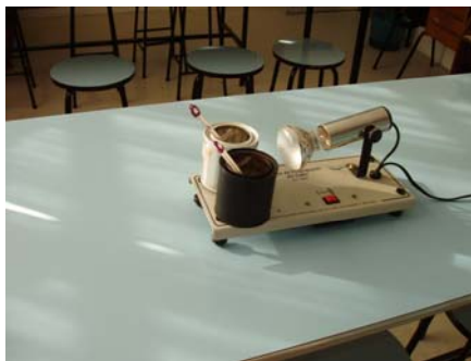
Fig. 3.5: latas com termômetros e lâmpada.
