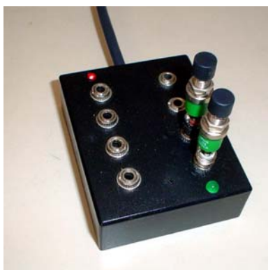
Fig. 25 - Caixas de entrada com chaves push button.
