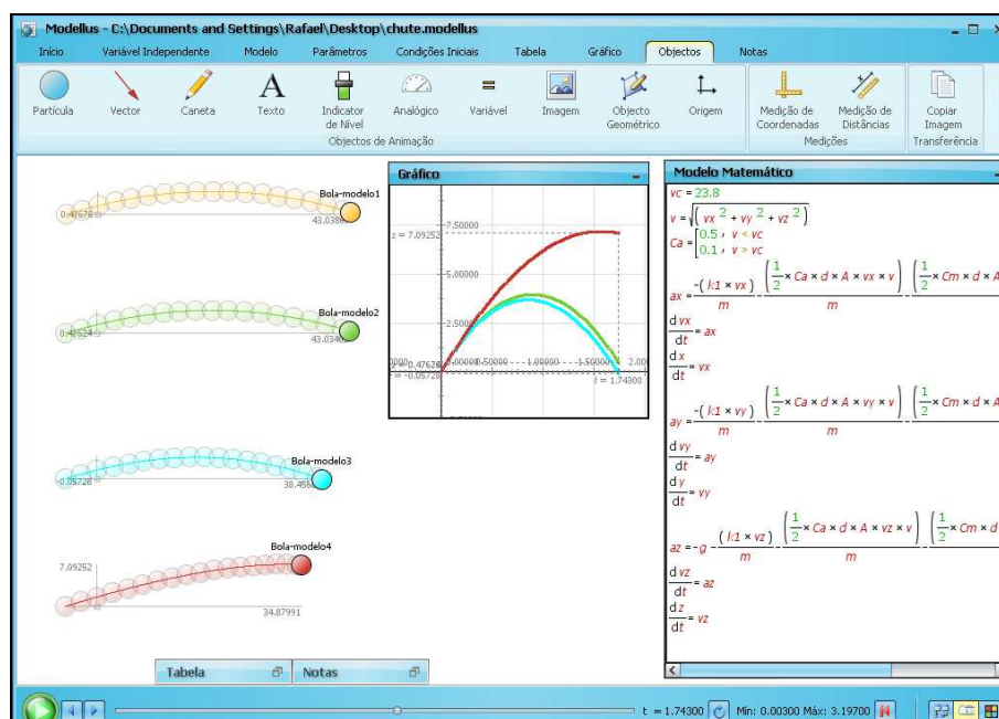
Figura 3. As quatro trajetórias descritas pela bola chutada por Pelé, em vista das diferentes idealizações e aproximações assumidas em cada caso na simulação com o Modellus 4.01 .
