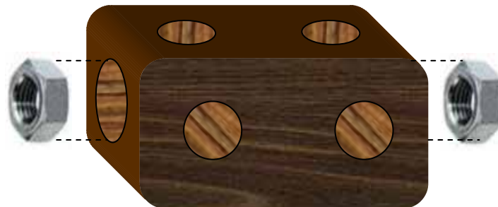
Figura 3: Peça do tipo 2 – Detalhe da inserção das porcas nas bases
