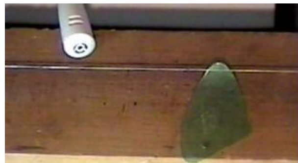
Figura 6. Detalhes mostrando o microfone e a paleta, prestes a tanger um fio de aço.
