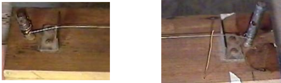
Figura 4. Os eixos usados para esticar os fios. Ao lado do eixo maior aparece um ponteiro
